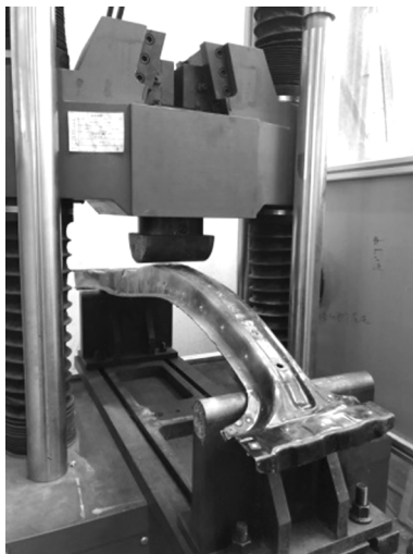
图 7 样件三点弯曲试验图
